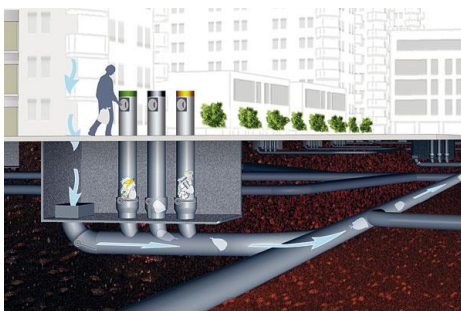
Fig. I. 5 : Exemple de Collecte souterraine pneumatique [5]
