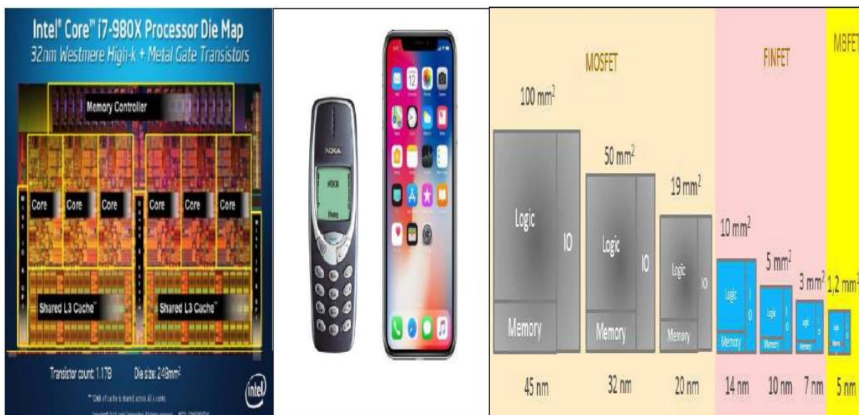
Figure II.1: à gauche : Image de l'architecture d'un processeur Intel Core I7 [1], au milieu: Nokia 3310, 2000 avec un demi-million de transistors, et L'iPhone X, 2017, avec plus de 4,3 milliards de transistors [3], à droite: la miniaturisation des transistors de 45 nm à 7 nm [4].
