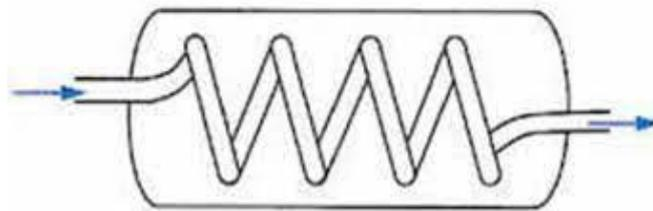
Figure I. 1. Echangeur monotube. [2]
