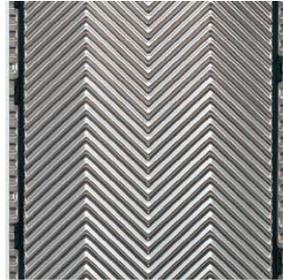
Figure I. 22. Profil d'écoulement.
