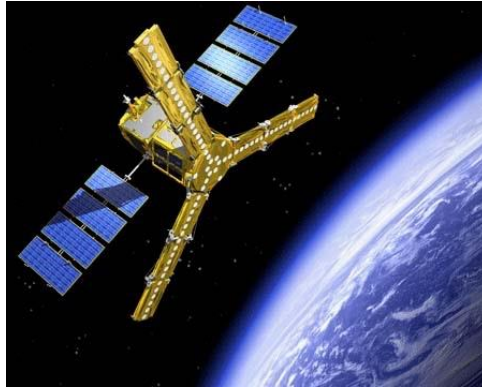
Figure I- 19 : Réseaux d’antennes de SMOS SAT [I-19].
