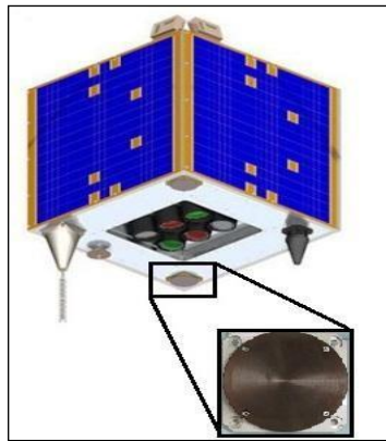
Figure I- 17 : Antenne patch microruban bande S pour microsatellite de Surrey SSTL [20].
