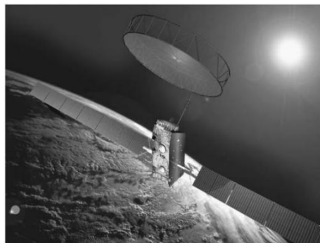
Figure I- 18 : Antenne à réflecteur (AstroMesh) d'INMARSAT-4 [I-19].
