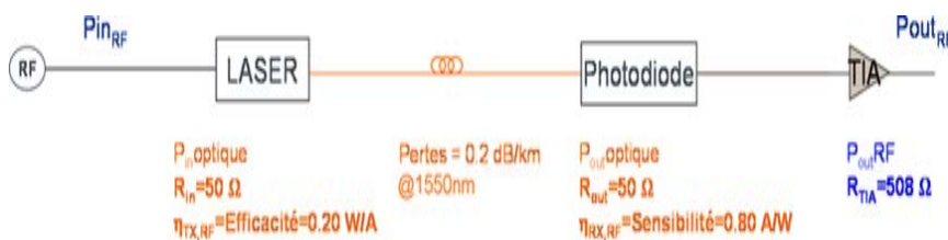
Figure. 3.10 – Principales caractéristiques d'une liaison radio sur fibre avec un ampli- cateur transimpédance
