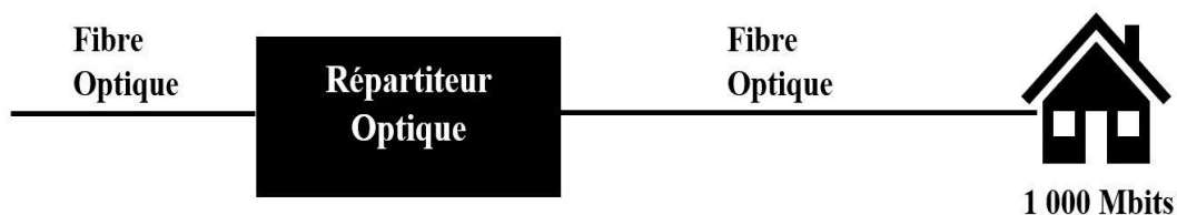
Figure II-1 Structure d'un réseau FTTH
