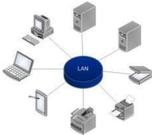
Figure I.3 : Exemple d'un réseau LAN.
