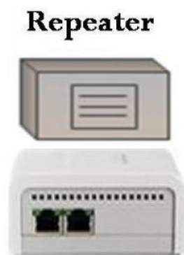
Figure I.15 : Exemple d'un répéteur ( Repeater ).
