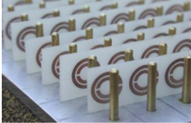
Figure I.9 : La structure proposée par D. Smith qui combine les fils minces et les SRR pour avoir un milieu doublement négatif (métamatériaux) .
