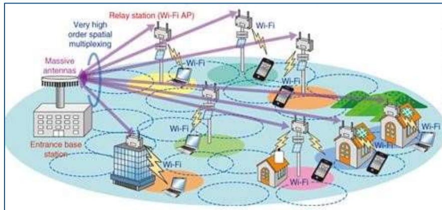
Figure II.2 : Exemple d'utilisation d'une antenne à formation de faisceau utilisée pour connecter des points d'accès Wi-Fi [15]
