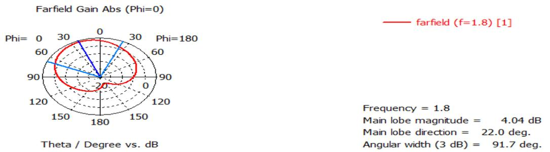
Figure III-22: Diagramme de rayonnement 2D de l'antenne MIMO dans le plan E à la fréquence 1.8GHz.
