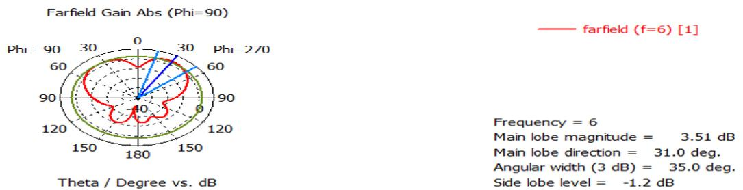
Figure III-19: Diagramme de rayonnement 2D ( $\phi=90$ ) de l'antenne proposée à la fréquence 6GHz.
