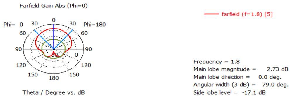
Figure III-30: Diagramme de rayonnement 2D de l'antenne MIMO à six éléments à la fréquence 1.8GHz.
