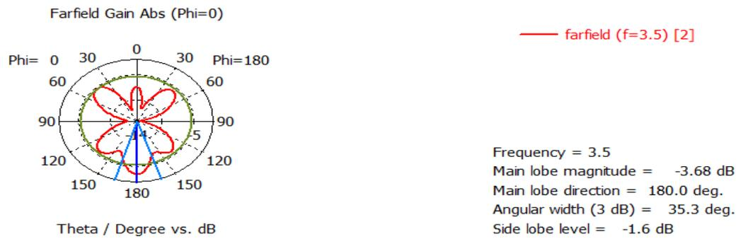
Figure III-32: Diagramme de rayonnement 2D de l'antenne MIMO à six éléments à la fréquence 3.5 GHz.
