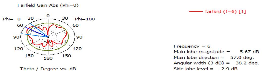
Figure III-26: Diagramme de rayonnement 2D de l'antenne MIMO dans le plan E à la fréquence 6GHz.
