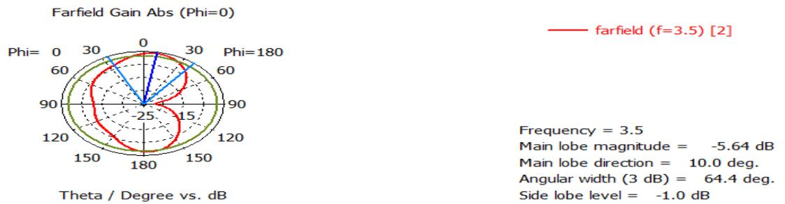
Figure III-24: Diagramme de rayonnement 2D de l'antenne MIMO dans le plan E à la fréquence 3.5GHz.
