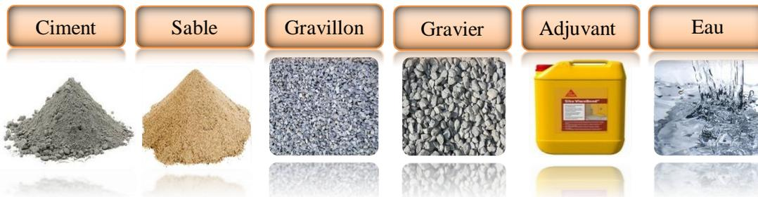
**Figure1.4** : composants du béton
