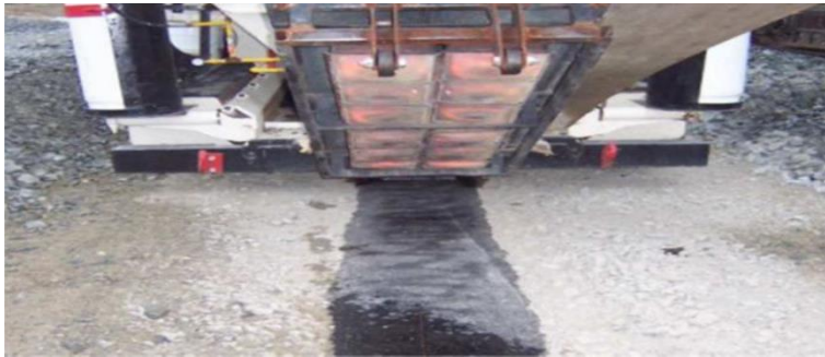
Figure III. 4: Système de chauffage à infrarouge à l'avant de la paveuse [33].
