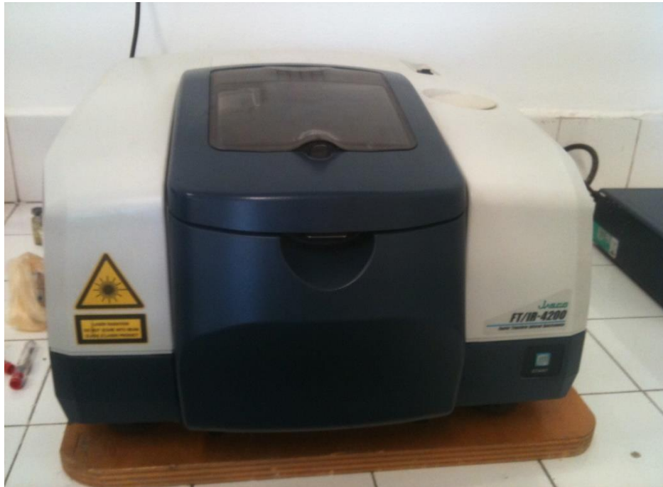
Figure III.1 : Analyseur Infrarouge à Transformée de Fourier FT/IR 4200
