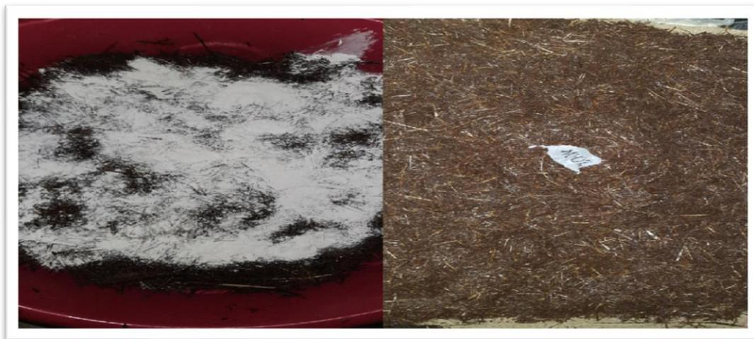
**Figure 9** : Etalage et addition de chaux sur le mélange paille + margine 50% (photos originales).
