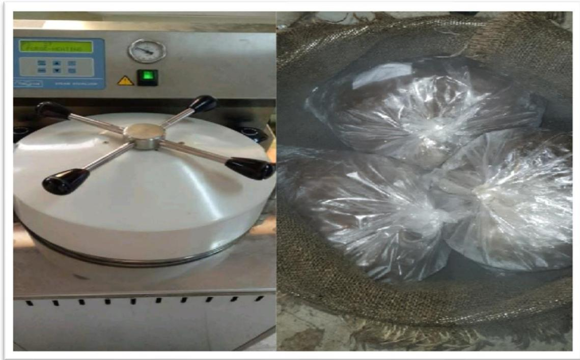
**Figure 10** : Stérilisation par l'autoclave (gauche) et la cocotte (droite) (photos originales).
