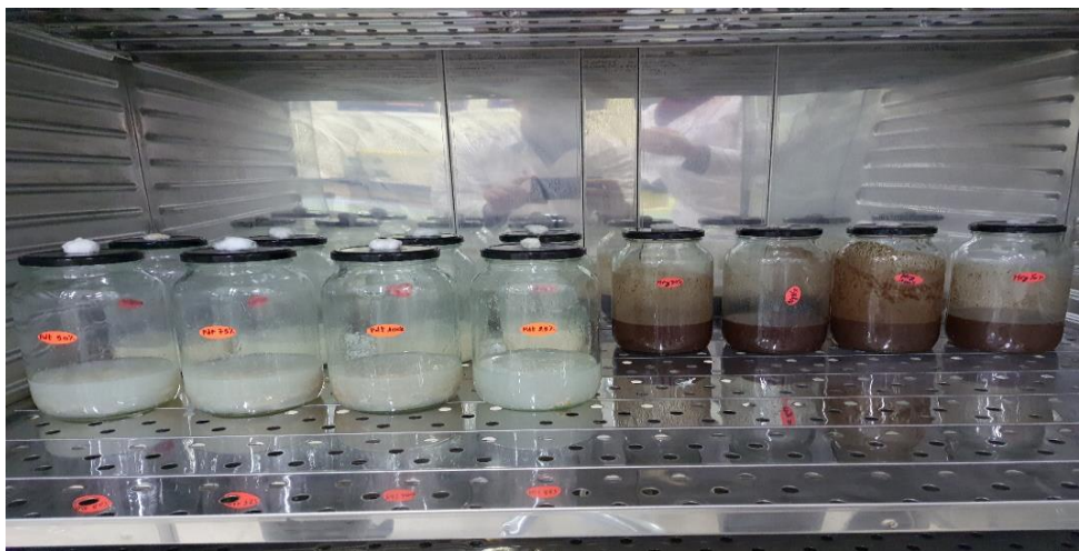
Figure 21 : Incubation des bocaux dans une étuve bactériologique. (Photo original)
