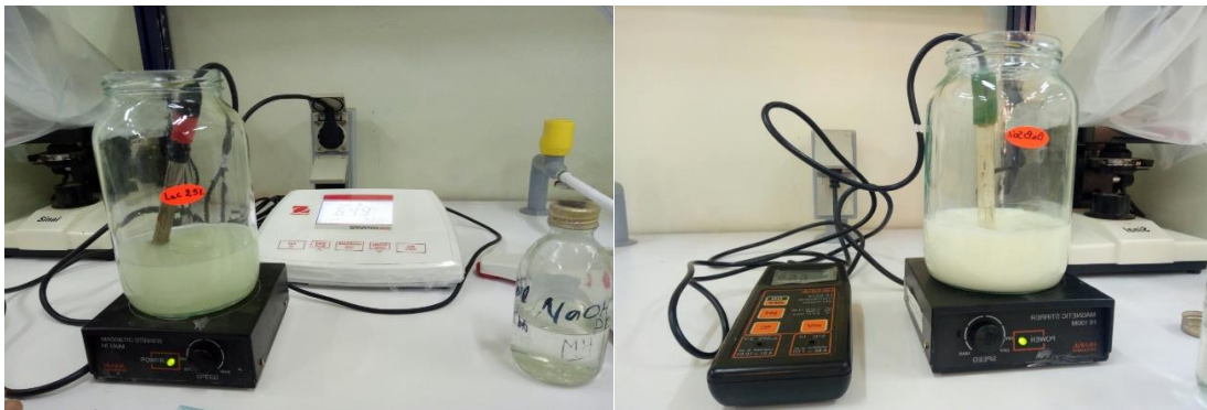
Figure16 : Détermination du pH des milieux liquides (photo original).
