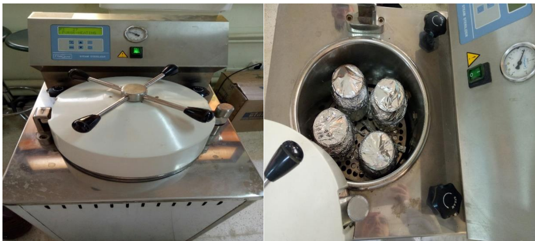
Figure17 : Stérilisation des bocaux à l'aide de l'autoclave. (Photo original)
