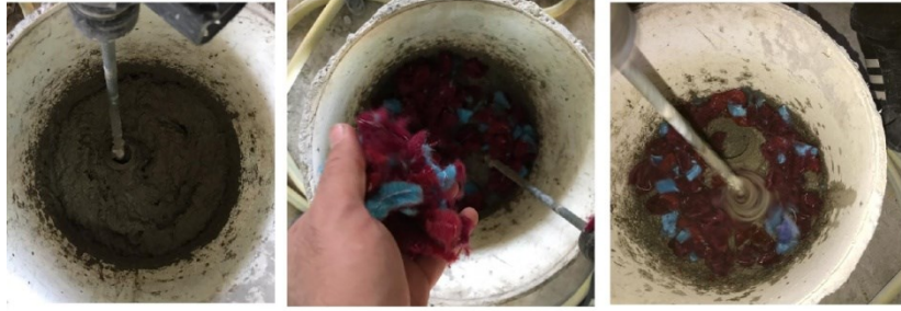
Figure III.9 : ajout des déchets au mortier
