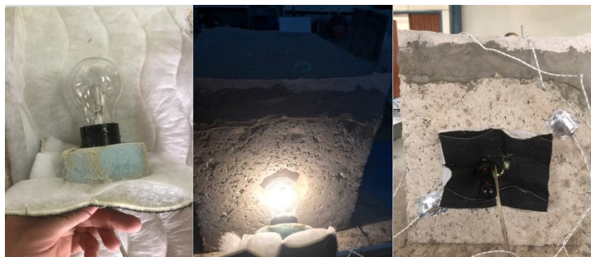
Figure III.19 : l'emplacement de la lampe dans l'enceinte.
