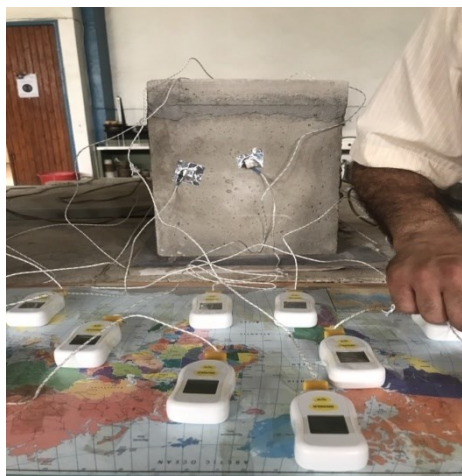
Figure III.17 : disposition des capteurs.
