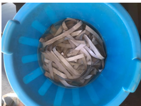
Figure III.3 : immersion du déchet carton dans l'eau.
