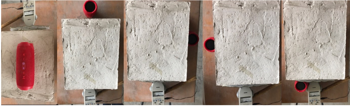
Figure III.22 : Les différents emplacements de la source sonore par rapport aux faces de l'enceinte.
