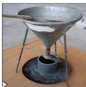
Figure III.1 : Caractérisation de la masse volumique apparente du ciment
