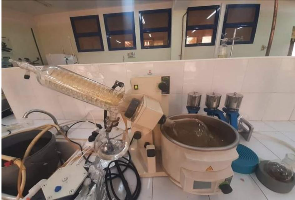
**Figure 22** : Evaporation du méthanol du filtrat à l'aide d'un rotavapor. (Photo originale).
