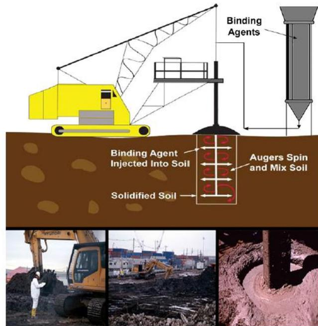
**Figure 4.1.** Procédé de solidification/stabilisation (S/S) d'un sol contaminé (Gitipour et al., 2014)
