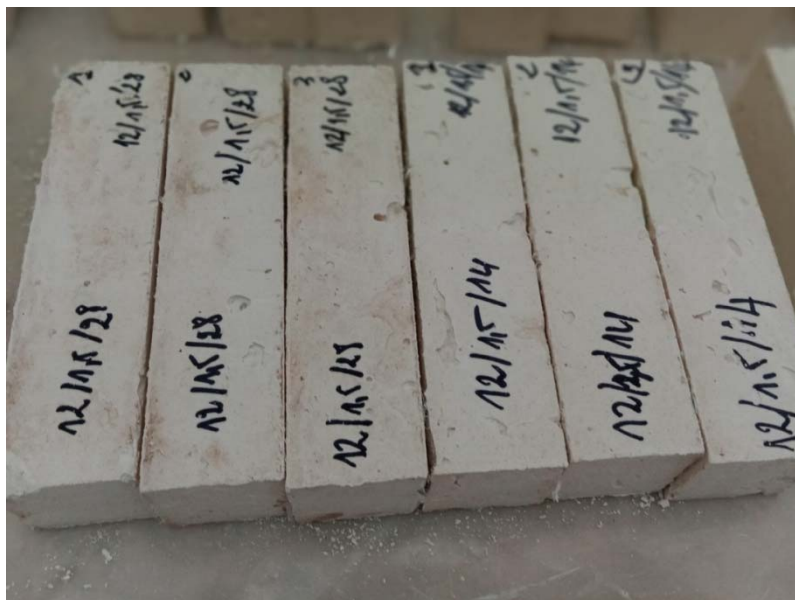
Figure IV.4 : Eprouvettes réalisées ( 4 \times 4 \times 16 \text{ cm}^3 )
