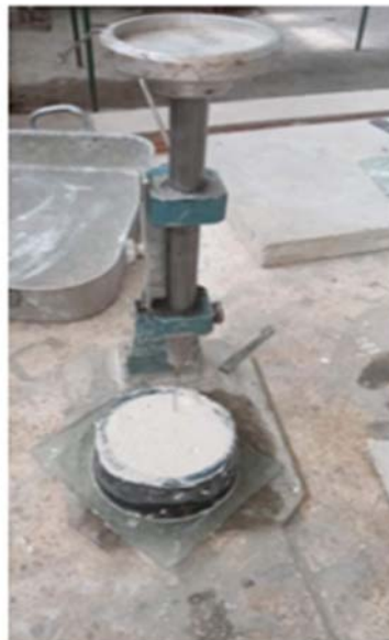
Figure IV.2 : Essai de prise avec l'appareil Vicat
