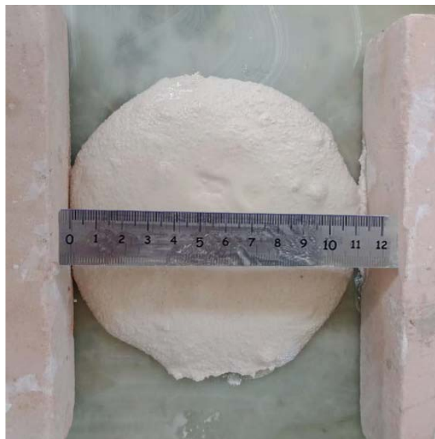
Figure IV.3 : Mesure de la consistance normale
