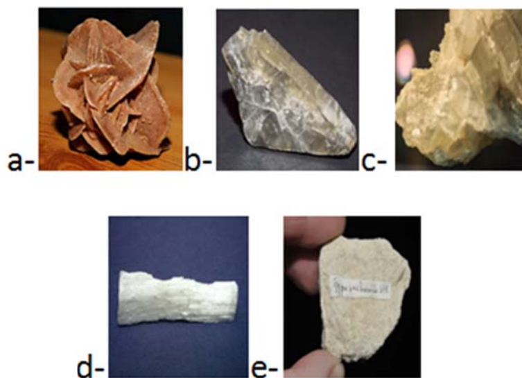
Figure I.3 : Les différents systèmes de cristallisation du gypse: a-Rose dessables, b- Gypse "fer de lance", c- Gypse lamellaire, d- Gypse fibreux, e- Gypse saccharoïde.
