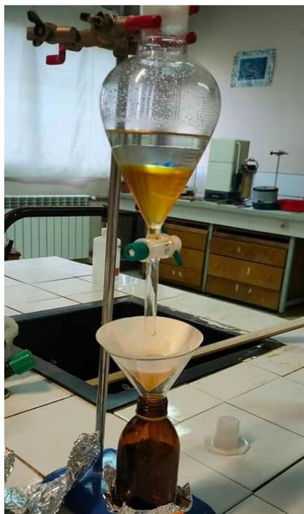
**Figure 17** : Dégraissage par l'hexane
