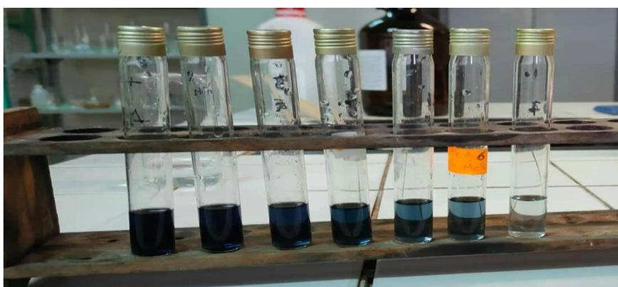
**Figure 20 :** Gamme d'étalonnage des polyphénols totaux (Photo originale)
