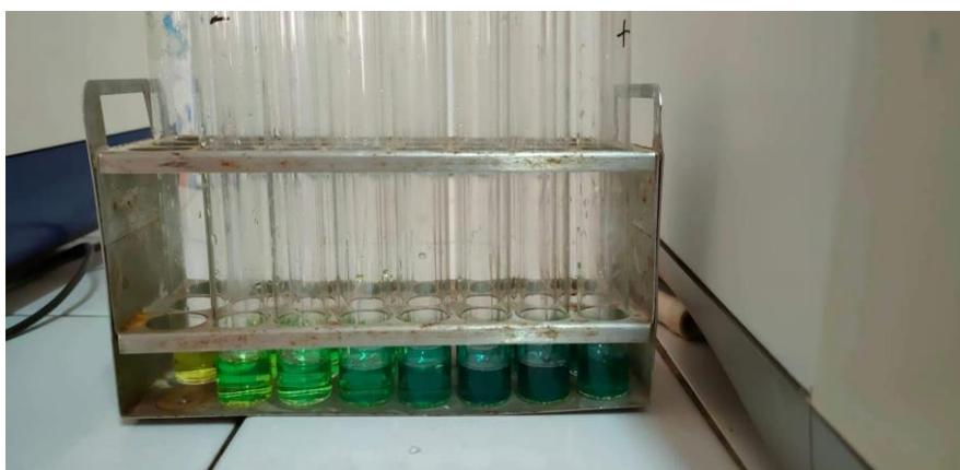
**Figure 24 : Gamme d'étalonnage de BHA (photo original)**
