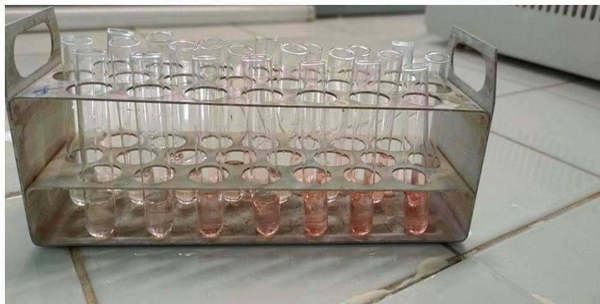
**Figure 22 :** Gamme d'étalonnage des tanins condensés (Photo originale)
