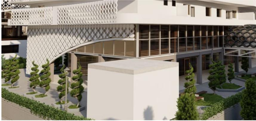
**Figure 67 : Niveau du RDC et R+1 en mur rideau et traité en moucharabieh <sup>111</sup>**
