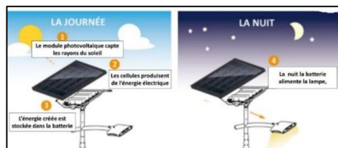
Figure105. Principe de production d'electricite
