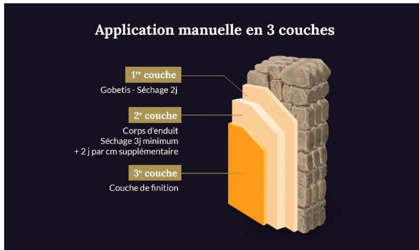
**Figure 122: schéma des couches d'enduit**
