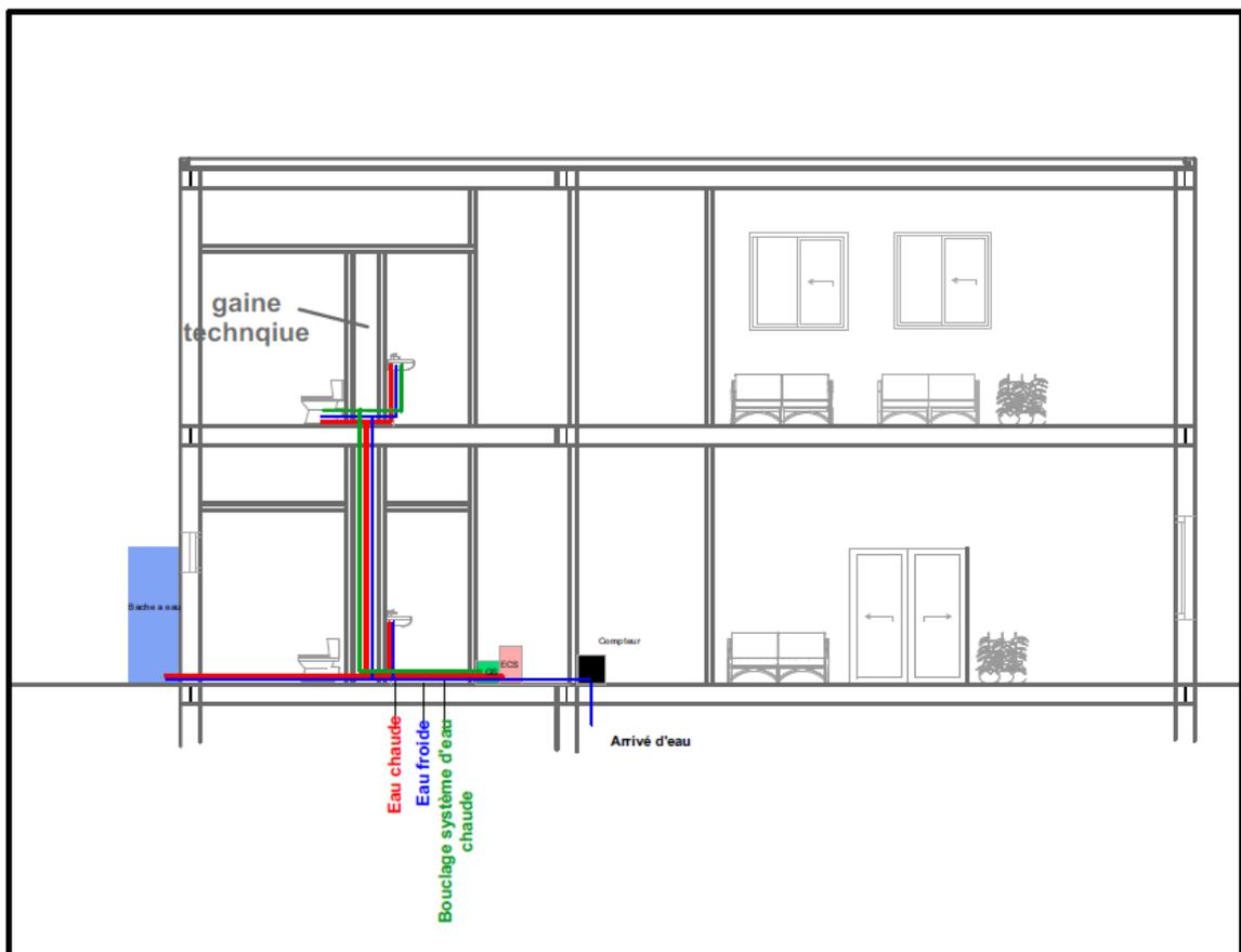
Figure 117: coupe schématique d'alimentation en eau potable
