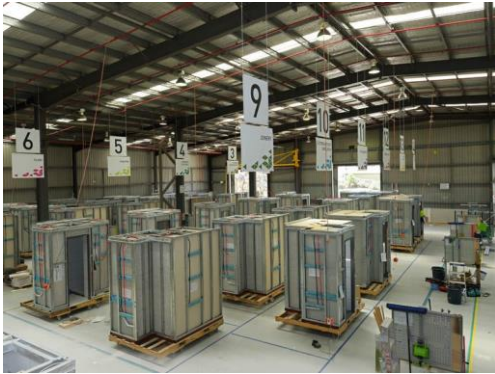
Figure 20: des modules de salles de bain
