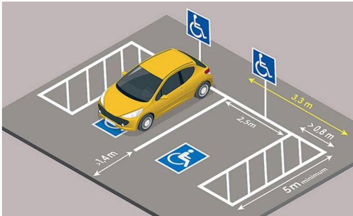
Figure 127 : Les dimensions nécessaires pour les parkings
