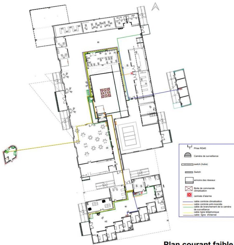
Figure 165 : Plan de courant faible
