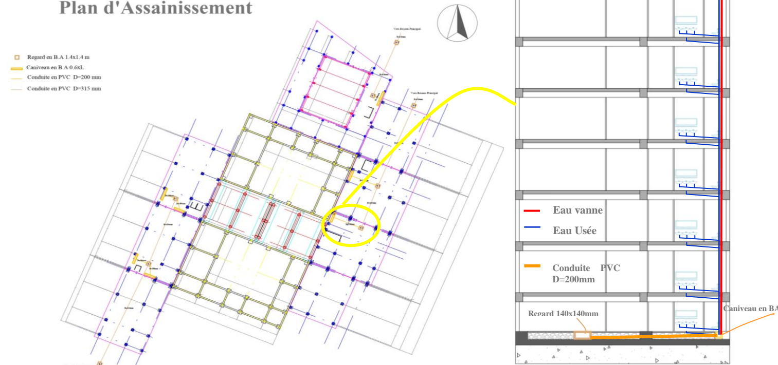
Planche 23. Plan et Coupe schématique de l'évacuation des eaux usées et eaux vannes. 121
