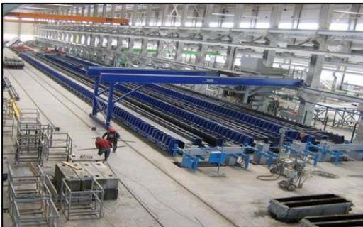
**Figure 06 :** Préfabrication en usine (Source :
