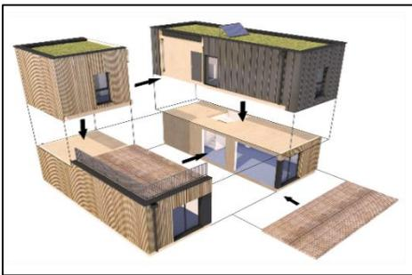
**Figure32:** Construction Modulaire « hors site »
