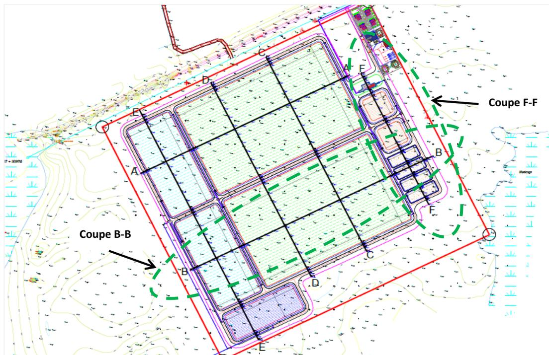
**Figure 3.1** Plan de masse de la station d'épuration
