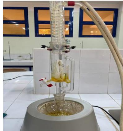
**Figure n°11:** Extraction méthanolique par Soxhlet.
