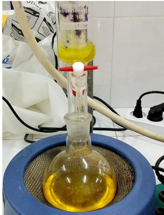
Figure 15 : L'extraction des huiles fixes des pétales de safran sèche par la méthode de Soxhlet (HADDADI, 2022).
