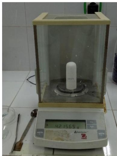
Figure 14 : cartouche rempli avec les pétales de safran sèche, pesé dans une balance analytique (HADDADI, 2022).
