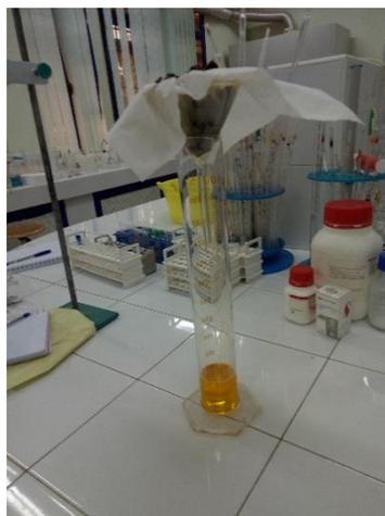
Figure 22 : la filtration de l'extrait dichlorométhanique (**HADDADI, 2022**).
