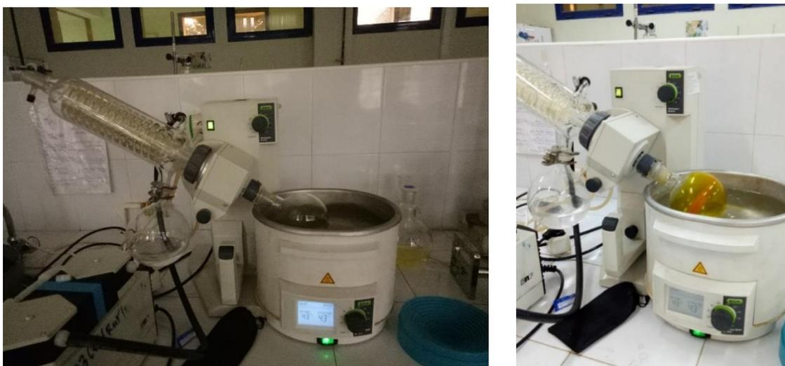
Figure 17 : la séparation entre les lipides et l'hexane par l'évaporation sous vide avec le Rotavapor (HADDADI, 2022).
