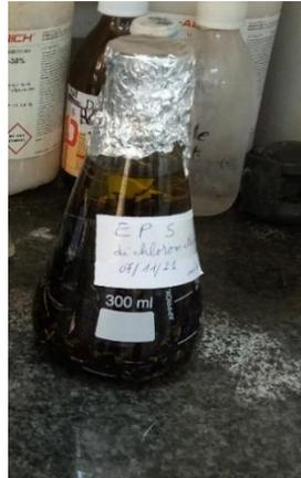
Figure 21 : la macération des pétales de safran sèche dans le dichlorométhane (**HADDADI, 2022**).
