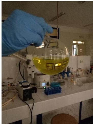
Figure 16 : le ballon qui contient les huiles fixes qu'est extraire des pétales de safran sèche avec l'hexane (le solvant d'extraction) (HADDADI, 2022).
