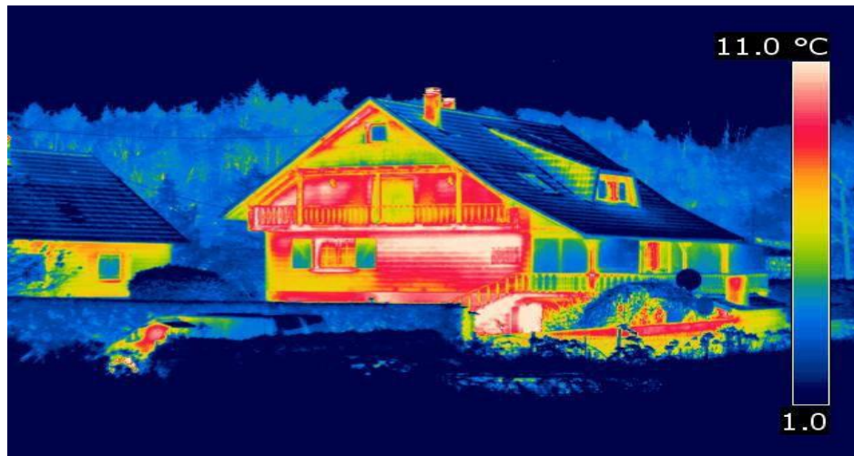
Figure I- 1 Exemple sur les ponts thermiques (Rouba Naaman-Beauvais, 2012)
