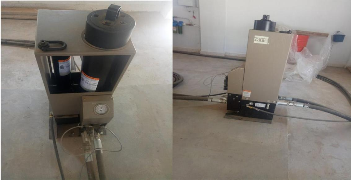
Figure 2. 20: HSM de la table vibrante.
