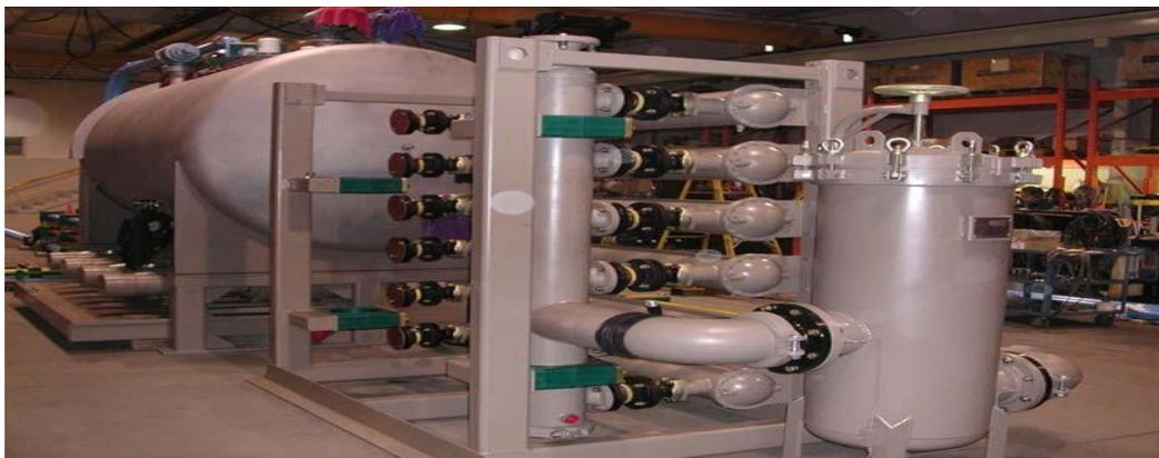
Figure 1. 26: Echangeur thermique du CGS [12].
