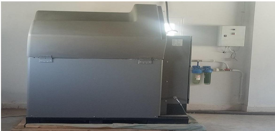
**Figure 2. 15:** La centrale hydraulique (HPU) de la table de RISAM.
