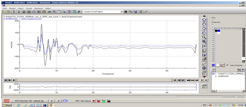
Figure 4. 37: Affichage des deux déplacements imposé (signal de Kobé) et mesuré sur la table.
