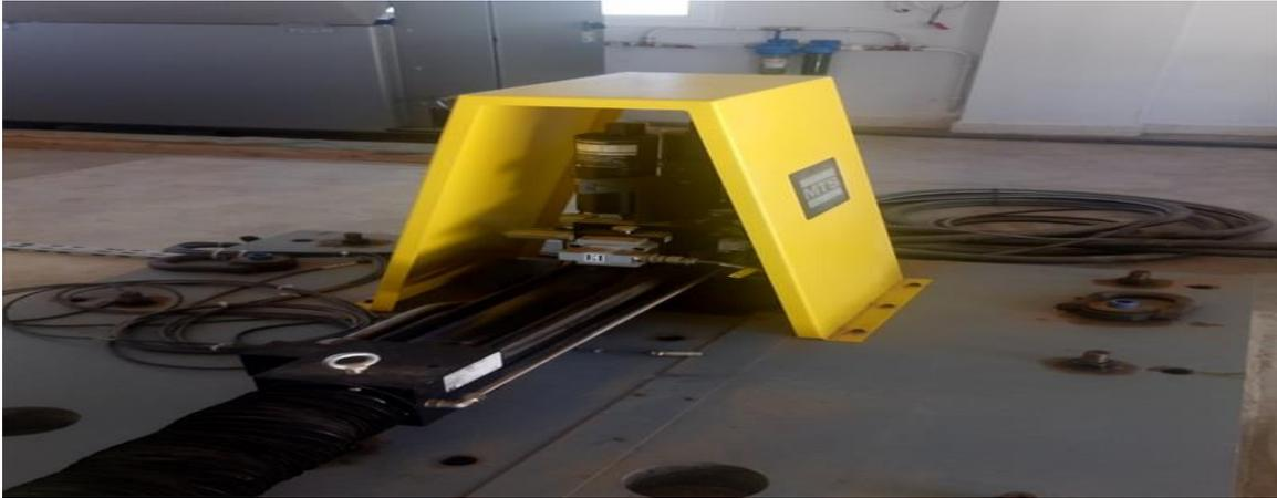
**Figure 2. 18:** Servovalve de la table vibrante de RISAM.
