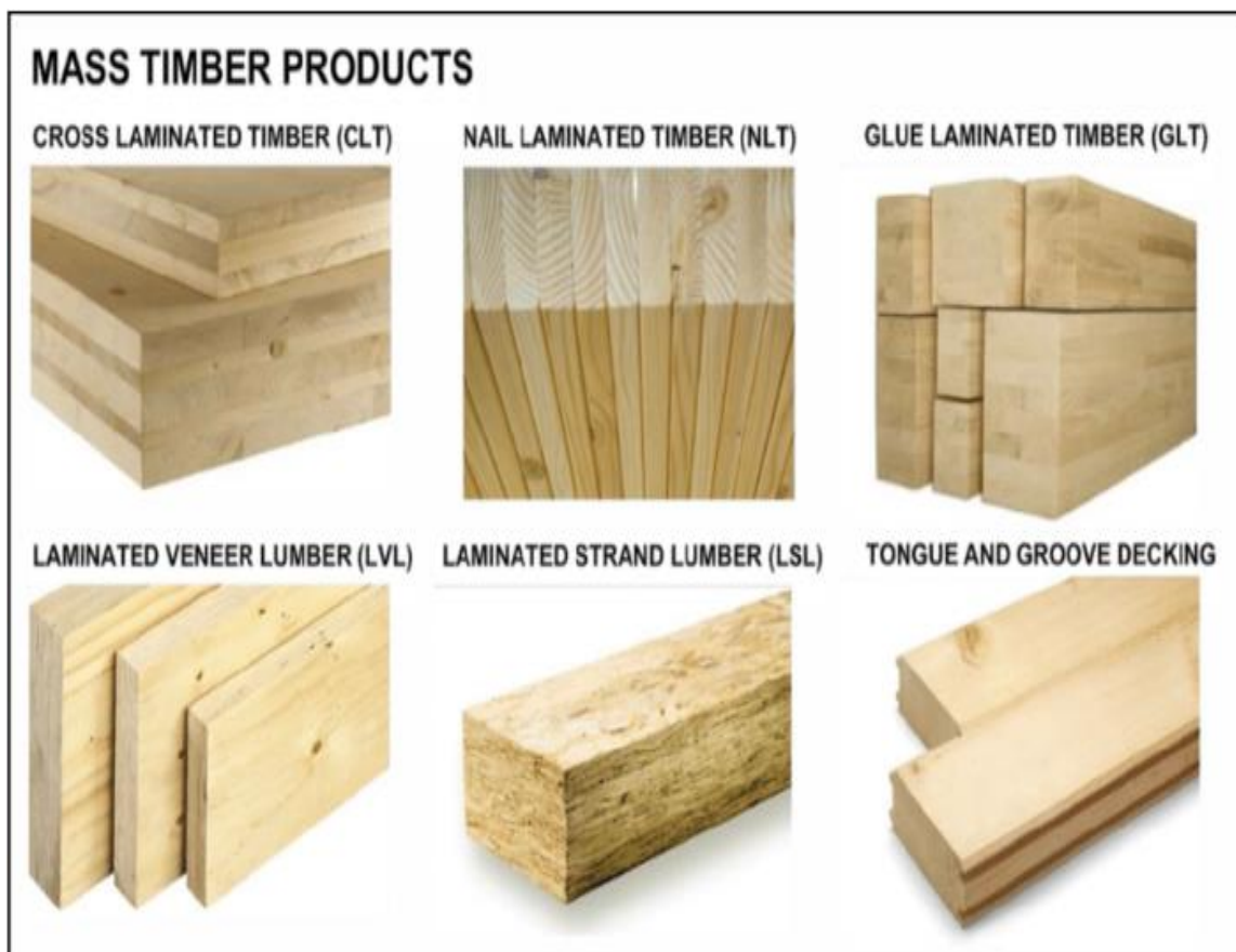
Figure I.11. Exemples de bois massif d'ingénierie [35]
