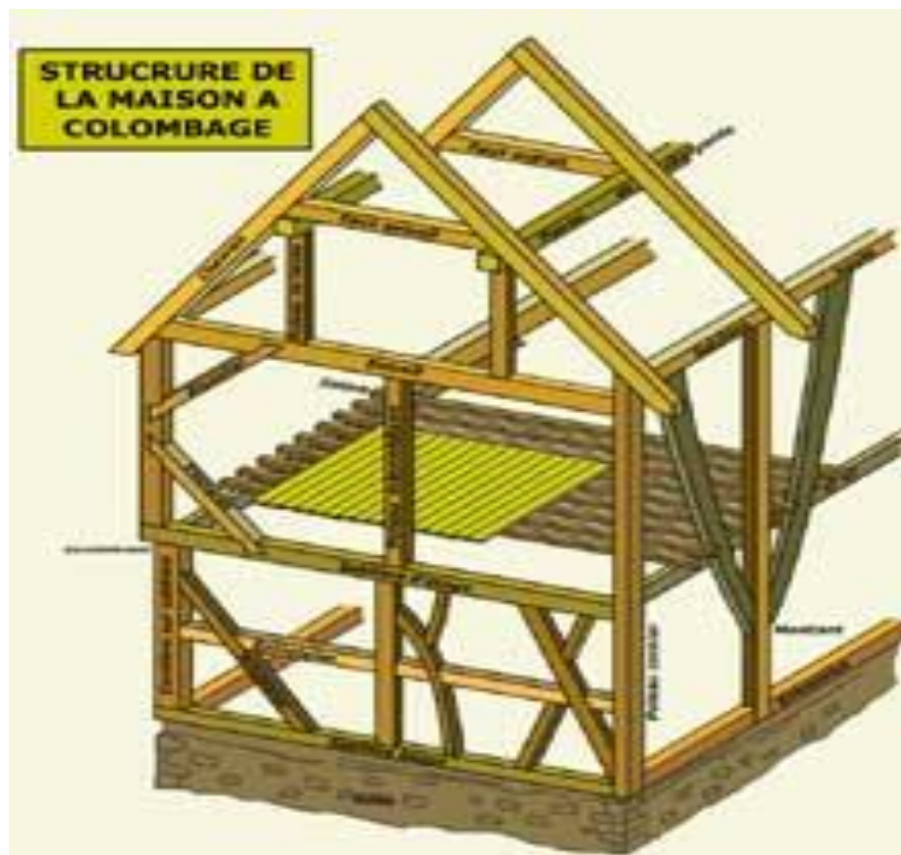
Figure I.12. Structure générale de la maison à colombage : bois courts (à gauche) ; bois longs (à droite) [38]
