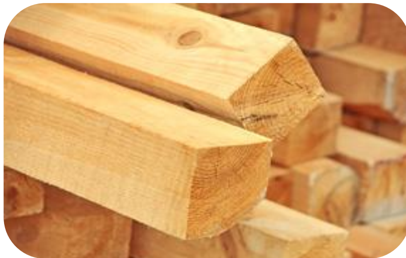
Figure I.4. Poutres en chêne [17]
