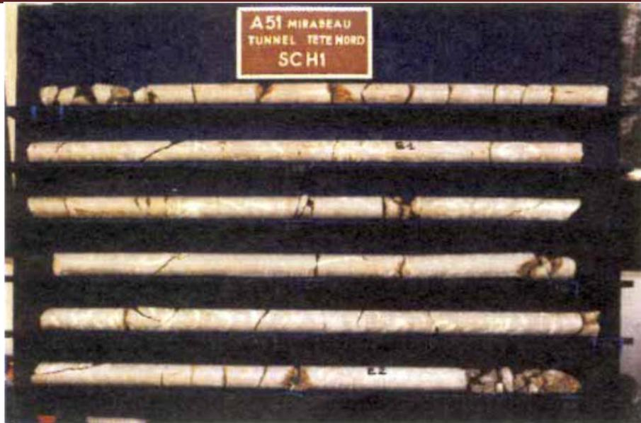
**Figure II-8 : sondage carottés (Héraud.H & Durville-L, 1997)**
