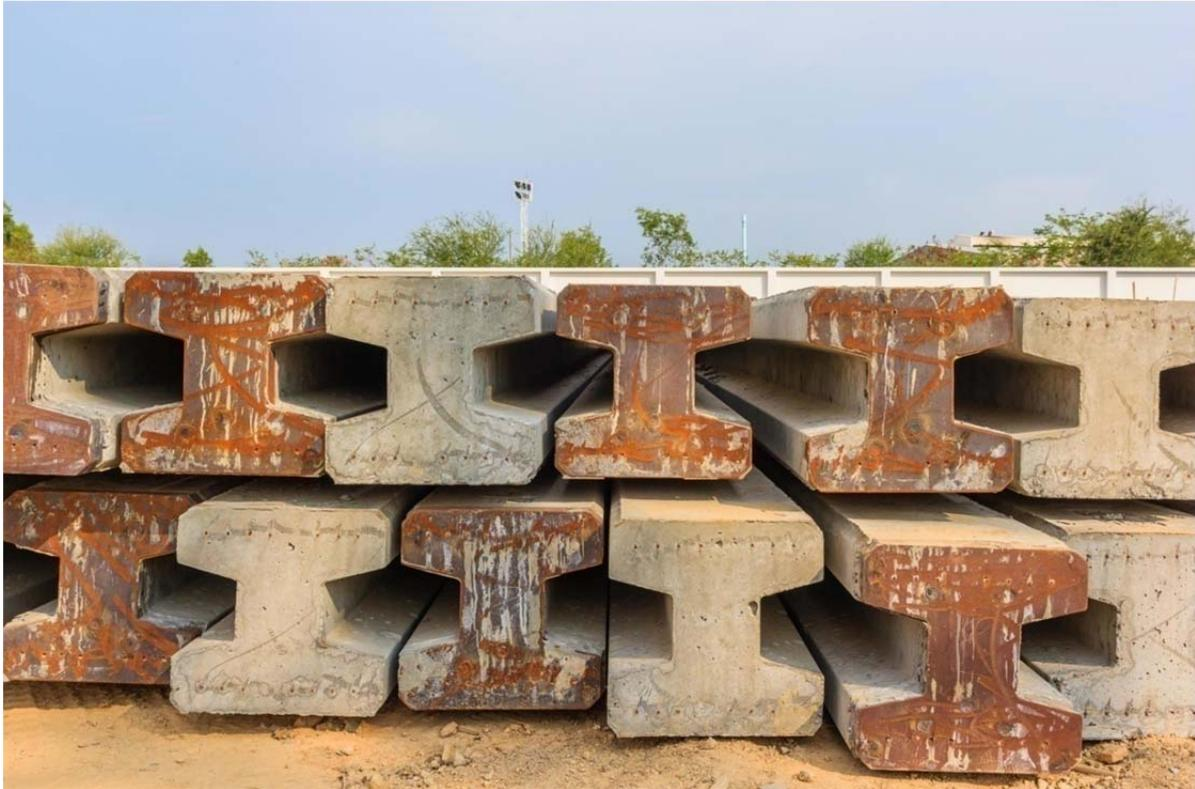
**Figure I-6 : pieux en béton précontrainte**
