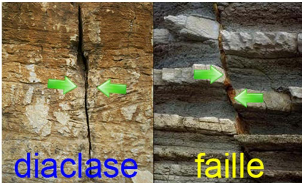
**Figure II-13: une faille et une diaclase (YAMATHOM 2016)**
