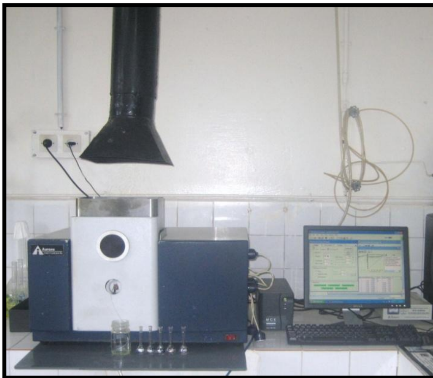
Figure 7 : Spectrophotomètre d'absorption atomique à flamme (SAAF) de type AURORA AL 1200 [www.docplayer.fr].
