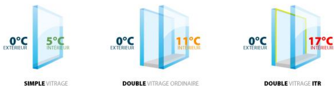
Figure 2-38 : un comparatif thermique entre les types de vitrage 41
