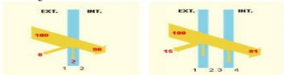
Figure 2-1: coefficient de la transmission lumineuse d'un simple vitrage et double vitrage 4
