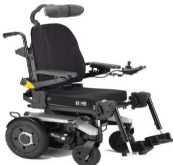
Pliant, il est moins volumineux qu'un fauteuil d'extérieur. Notons qu'il est cependant difficile et fatiguant pour la tierce personne de le plier. Son autonomie va de 10 à 16 km et sa vitesse est réglable de 0 à 6 km/h. On peut le mettre dans le coffre d'une voiture [12].
