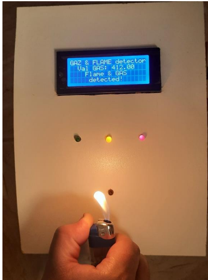
Figure III. 15 : Résultat obtenu en présence du gaz et de la flamme (FLAME & gaz detected).
