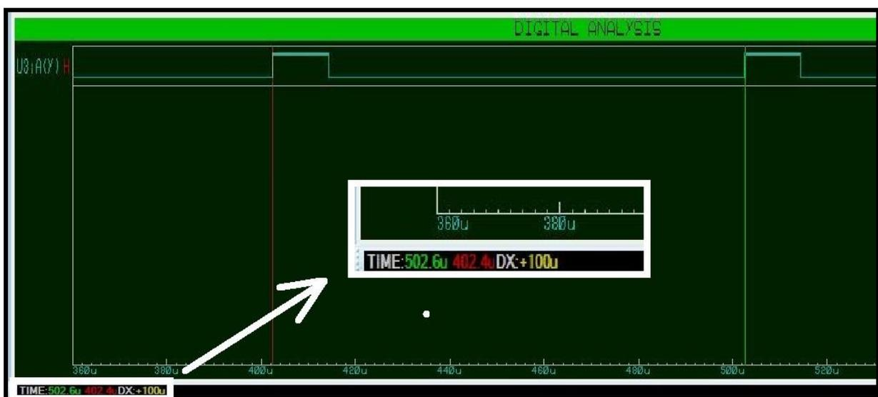
Figure III. 10 : le signal sortant du Trigger de schmitt
