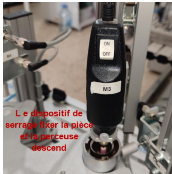
Le dispositif de serrage fixe la pièce et la perceuse descend
