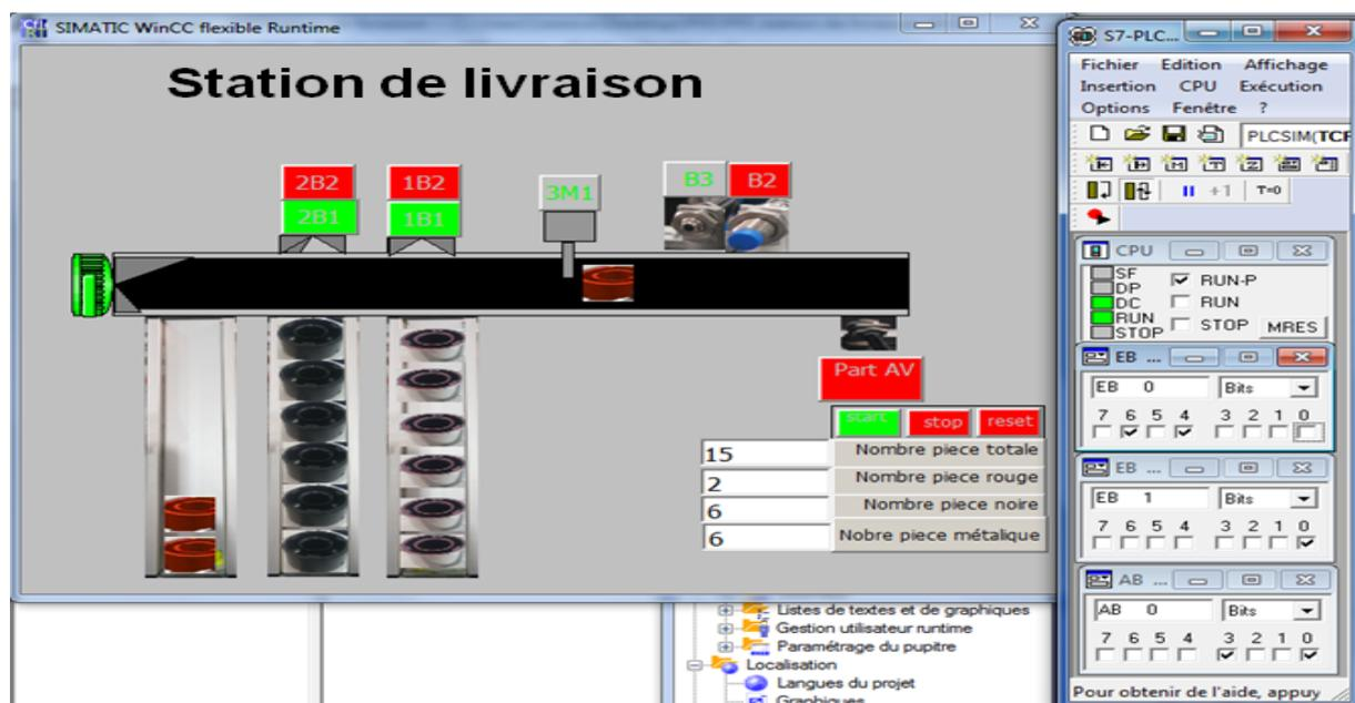
FIG. 4.42 : Simulation de la sous-station de livraison (PLCSIM et Runtime) (d).
