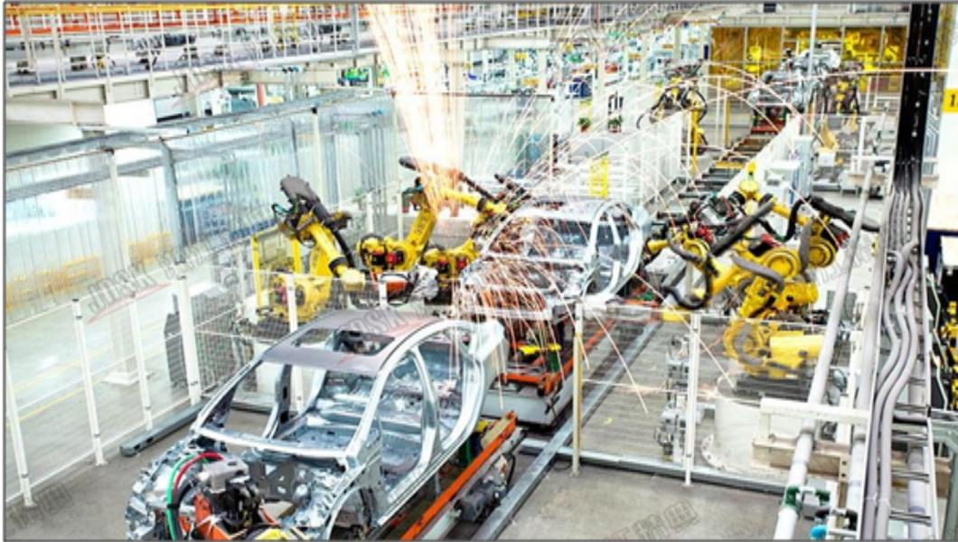
FIG. 1.1 : Chaîne de production en série automatisée destinée à souder la carrosserie des véhicules[6].
