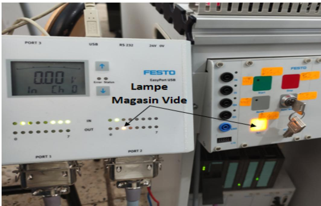
FIG. 3.70 : La synchronisation entre l'EasyPort et le pupitre de commande (c).
