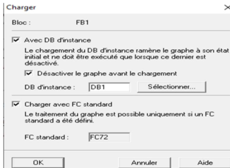
FIG. 3.103 : Chargement du bloc FB1 (partie fonctionnelle).
