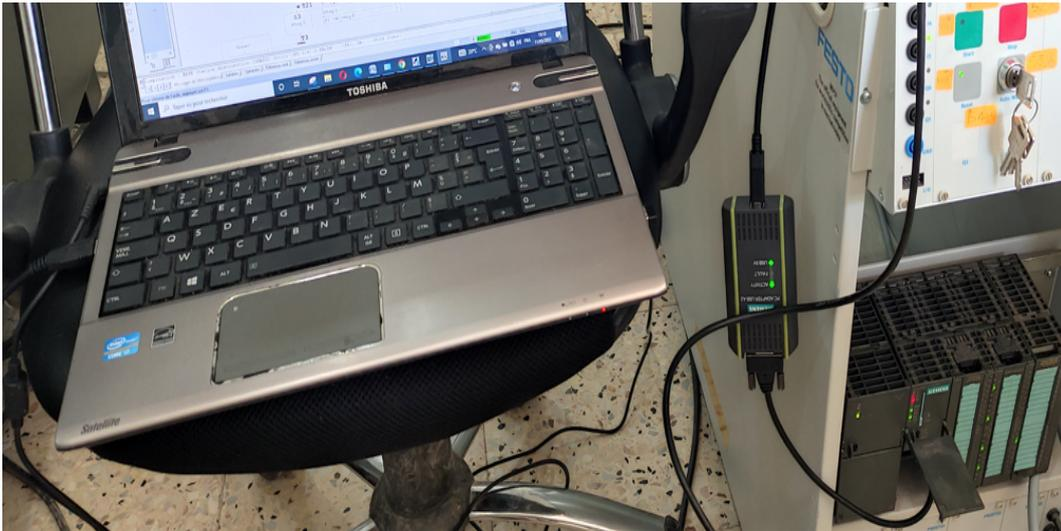
FIG. 3.74 : Branchement de l'automate avec le PC via l'adaptateur USB-MPI.
