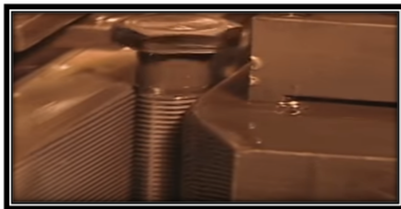
FIGURE 1.41 – L'étape du filetage de la vis.
