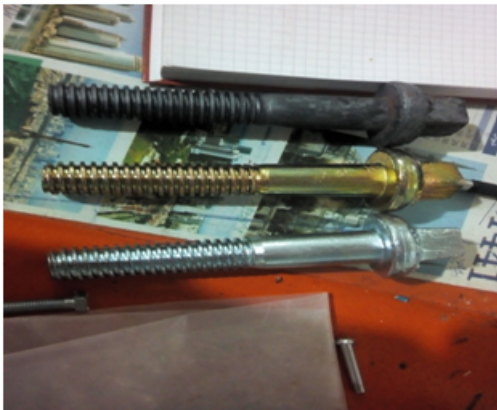
FIGURE 1.44 – Boulon avant et après le zingage.
