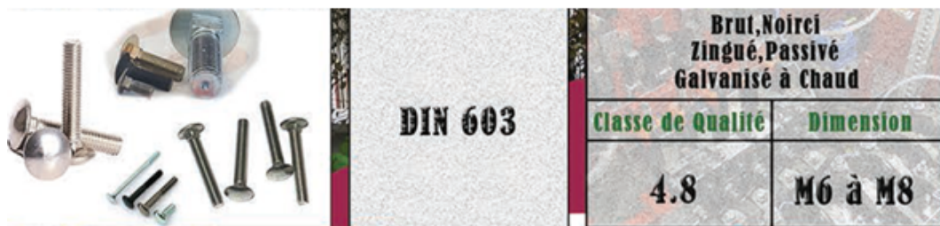
FIGURE 1.18 – Vis à tête ronde à collet carré[14].
