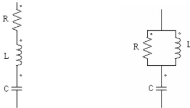
Figure I.3 a) Filtre passif résonnant b) Filtre passif amorti.
