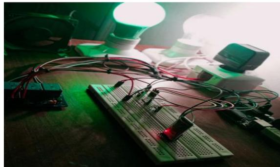
Figure 31. Mise en marche des équipements par la commande « allume tous »
