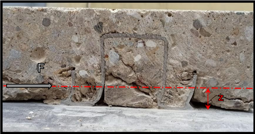
(b) Coupe sur la dalle de béton du spécimen avec les OCAL-(3x50).
