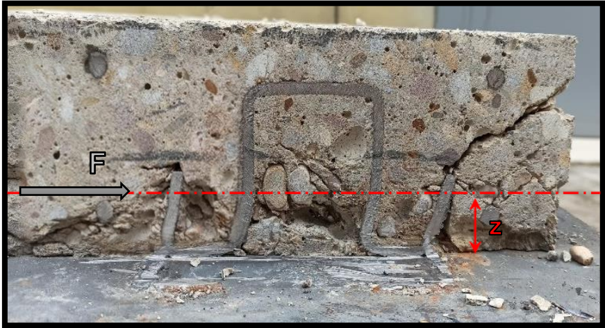
(c) Coupe sur la dalle de béton du spécimen avec les OCAL-(4x60)-S355.
