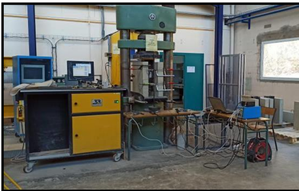
(c) Vue générale de l'essai de push-out
