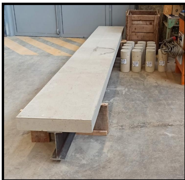
(g) Spécimens de poutre mixte prêt à être tester
