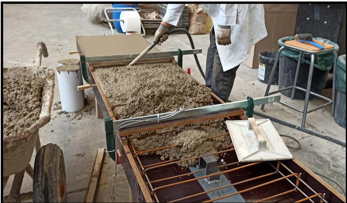
(e) Coulage et vibration du béton dans le coffrage en bois.
