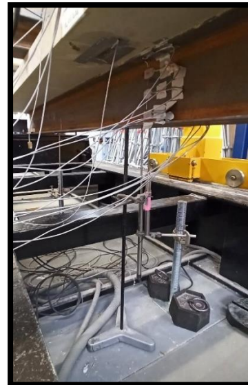
(c) Capteurs LVDT à mi-travée.
