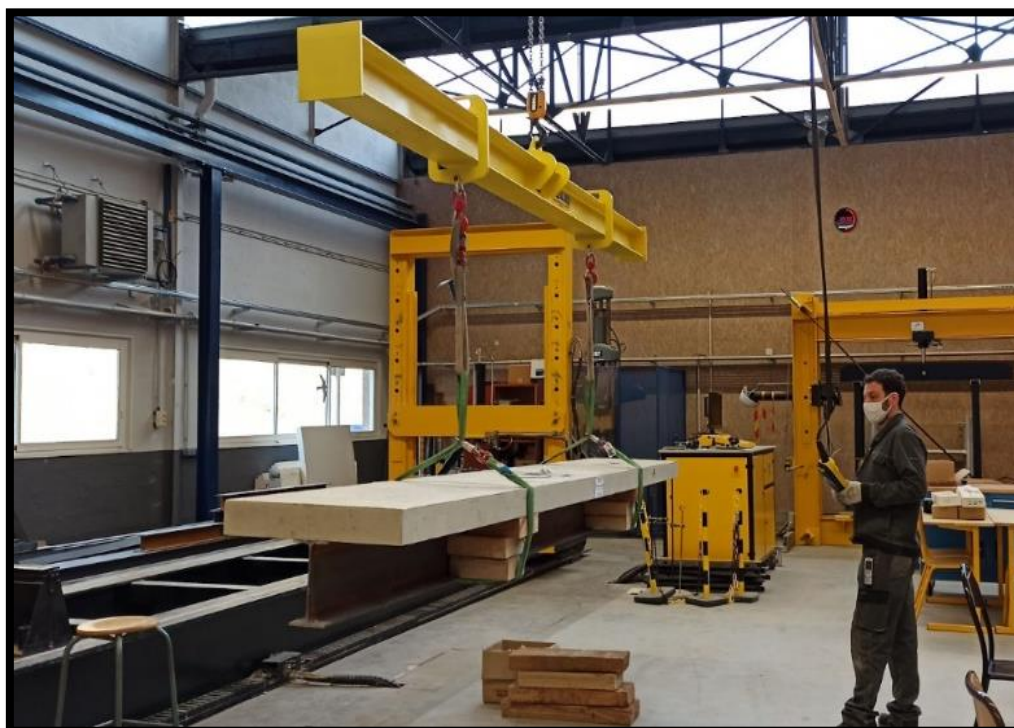
(a) Déplacement du spécimen vers le banc de flexion.
