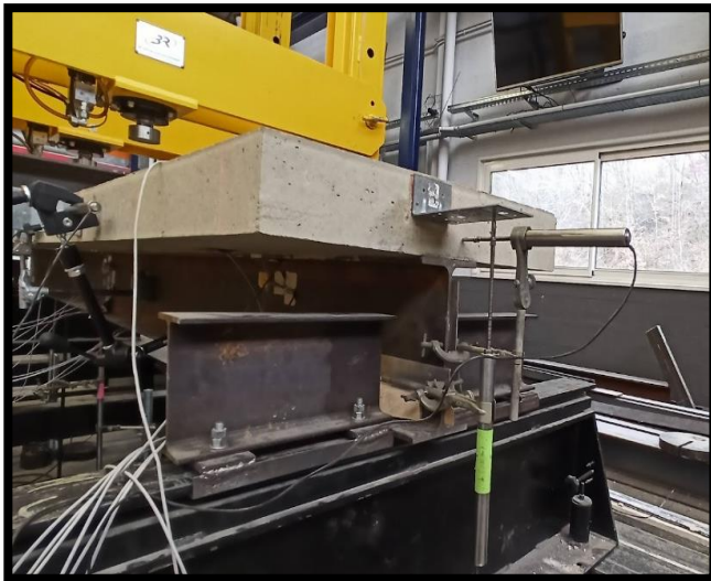
(b) Capteurs LVDT sur l'extrémité.
