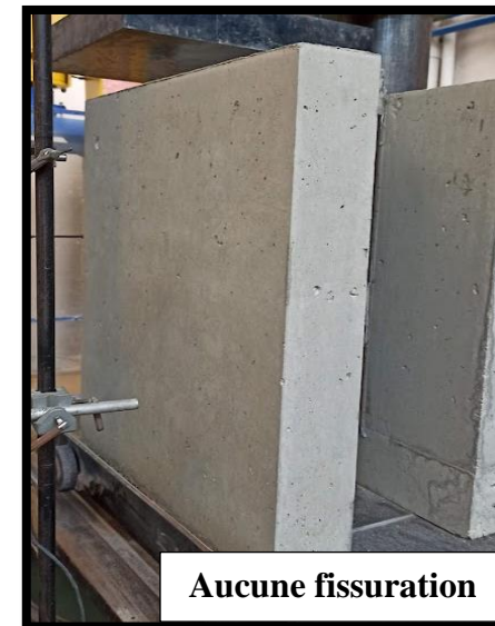
(b) Etat des dalles de béton des spécimens avec les OCPL-(3x50).
