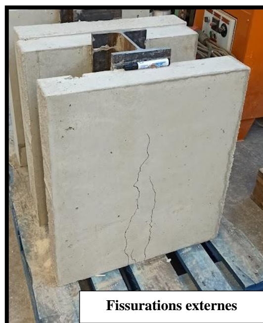
(b) Etat des dalles de béton des spécimens avec les OCAL-(3x50).
