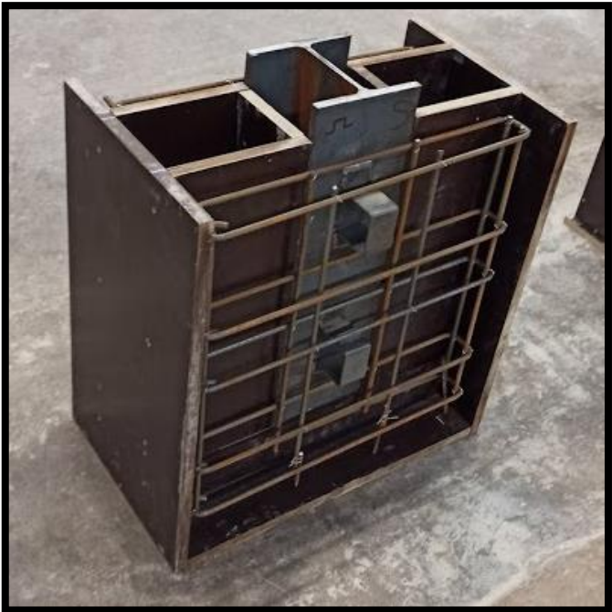
Figure 3.4 Préparation du spécimen de push-out avec les goujons G22
