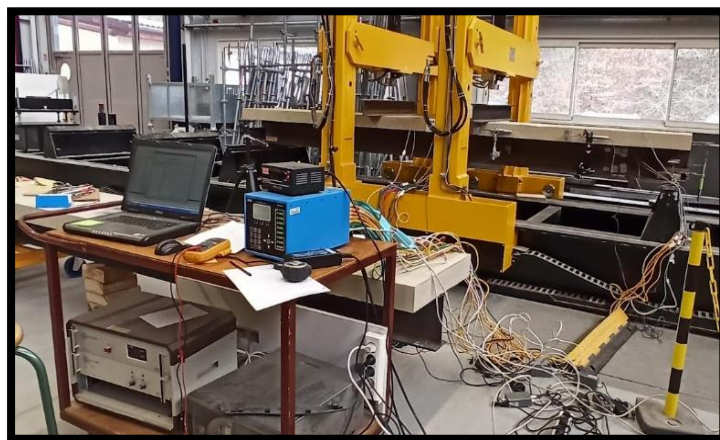
(d) Centrale d'acquisition des données 'Spyder-8'.
