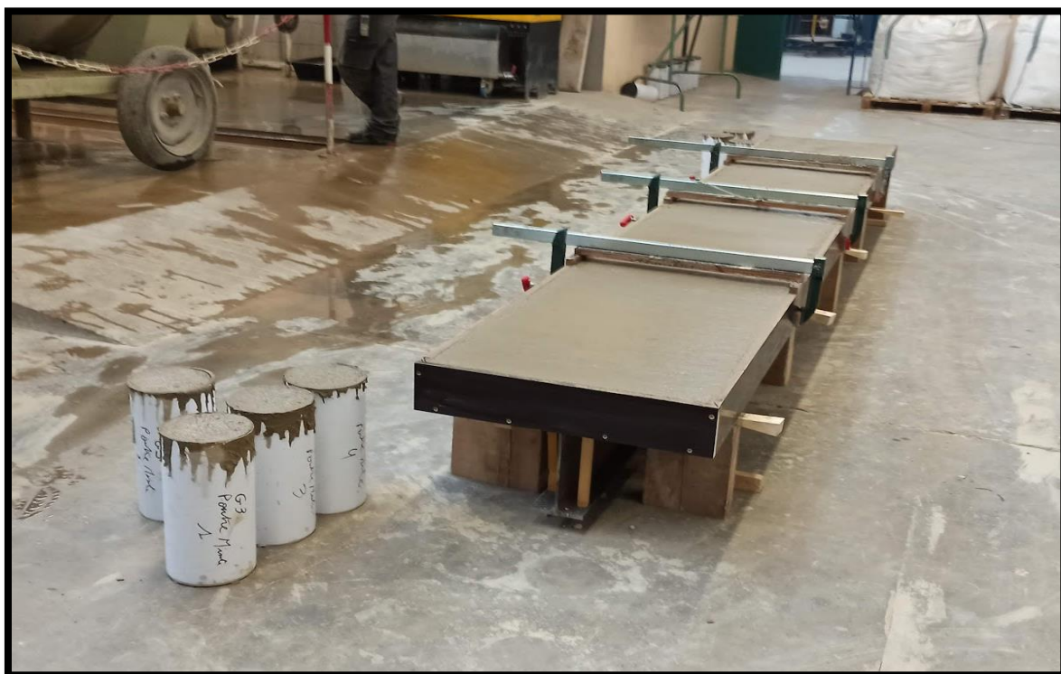
(f) Spécimen de poutre mixte et éprouvettes cylindriques coulés.
