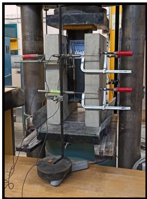
(b) Installation des LVDT
