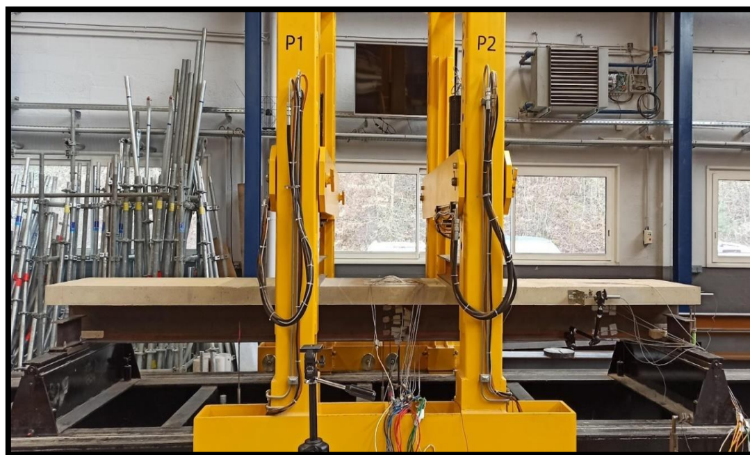
(c) Spécimen de poutre mixte dans le banc de flexion.
