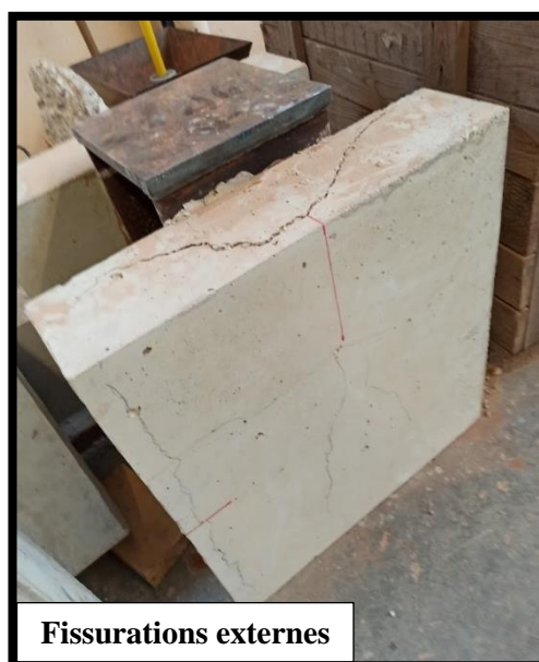
(b) Etat des dalles de béton des spécimens avec les G22.
