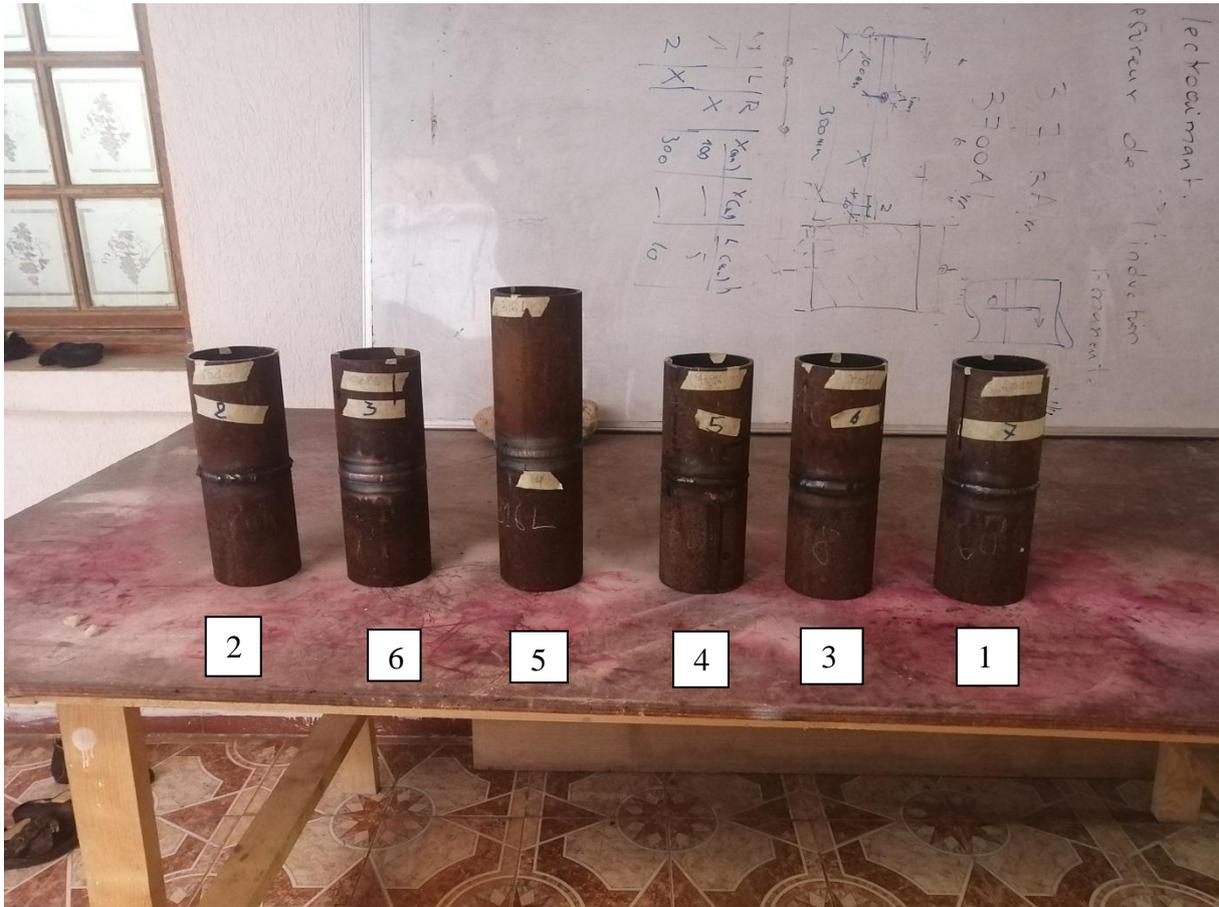
Figure III.4 : Tubes soudés
