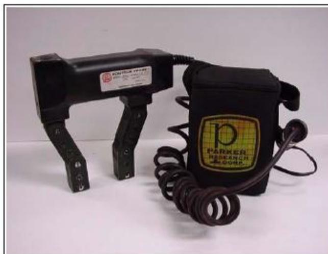
**Figure II.14 :** Appareil manuel de contrôle par magnétoscopie.
