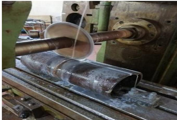
**Figure III.9 :** Prélèvements des éprouvettes sure une fraiseuse horizontale.
