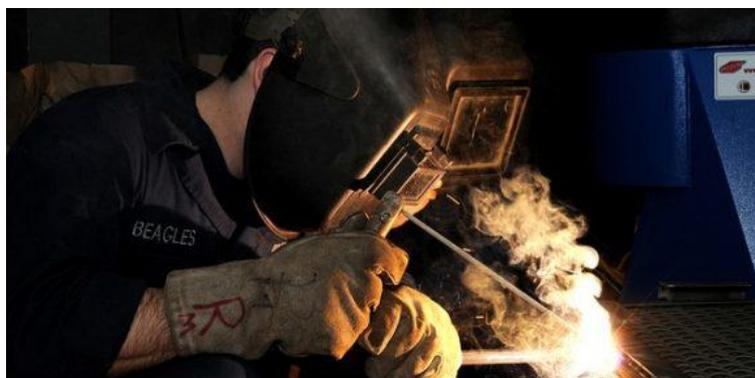
**Figure I.10** : soudage à l'arc à l'électrode enrobée SMAW [10].
