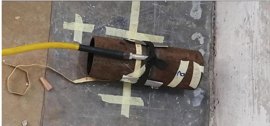
Figure III.7 : Tir radiographique méthode par contact
