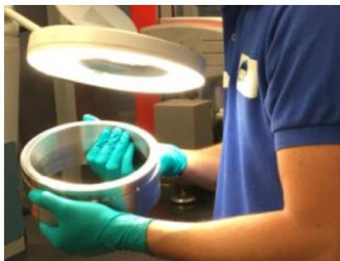
**Figure III.5 :** Contrôle visuel des tubes soudés
