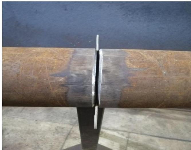
Figure III.3 : Position des tubes à assembler
