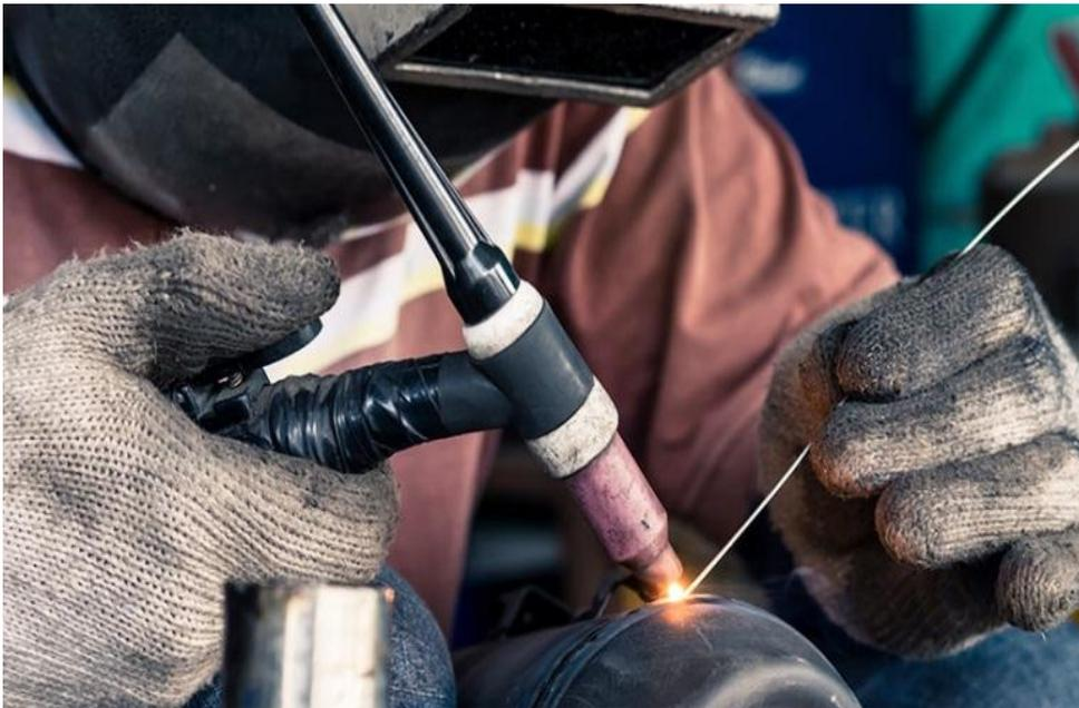
**Figure I.18** : soudage GTAW [15]
