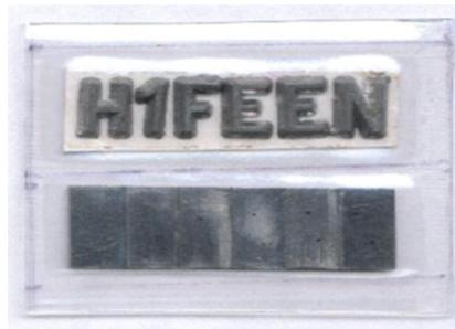
**Figure II.27 :** Indicateur qualité image a gradins
