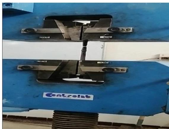
Figure III.12 : Epreuve après rupture.
