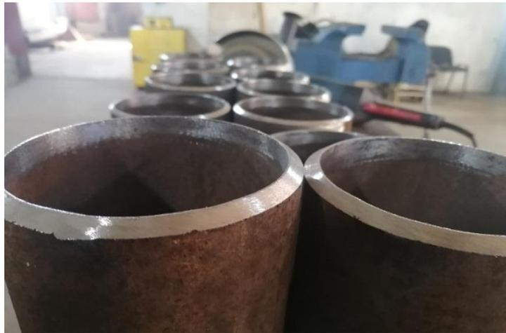
Figure III.2 : Préparations des chanfreins  $\alpha = 60^\circ$
