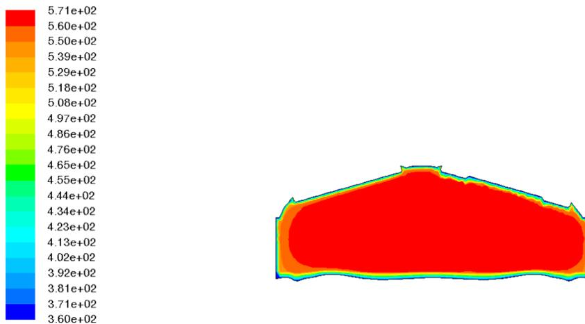
Figure 4. 8.a : Contours de la température (K) dans le cylindre à 690° vilebrequin
