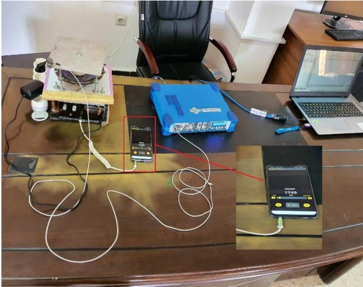
Figure 48: Générateur Andoroid (1743Hz)
