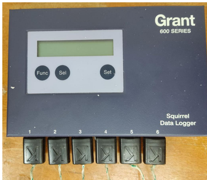
Fig.3. 4. Enregistreur de température OQ600
