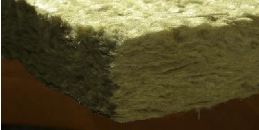
Fig.3. 3. Laine de roche (épaisseur de 7 cm)
