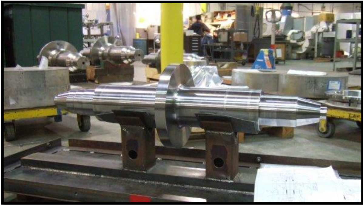
Figure IV. 15: Un arbre typique pour un turboexpandeur
