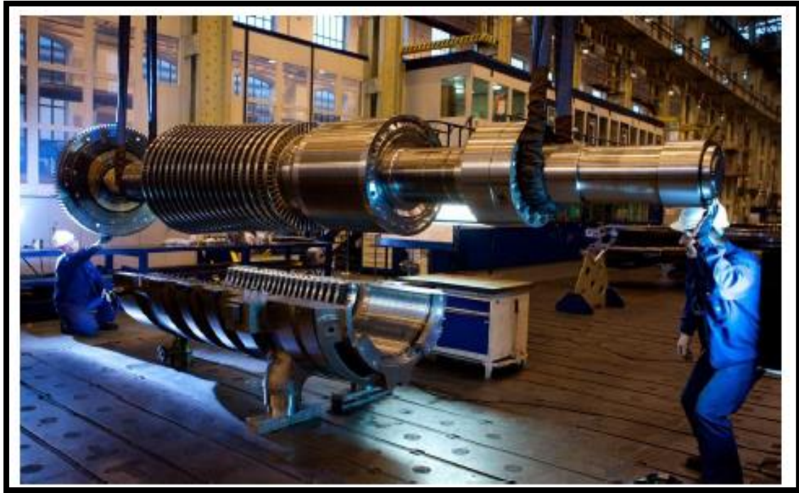
Figure III. 8: Turbine à vapeur (ALSTOM)
