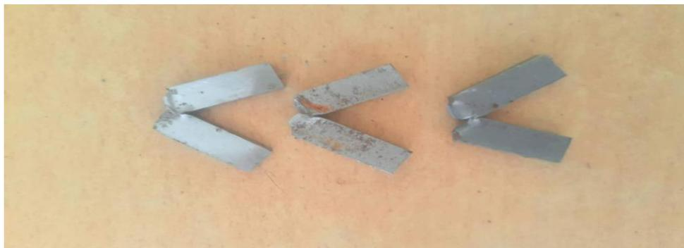
*Figure 5. 18 : Des éprouvettes de résilience après la rupture.*
