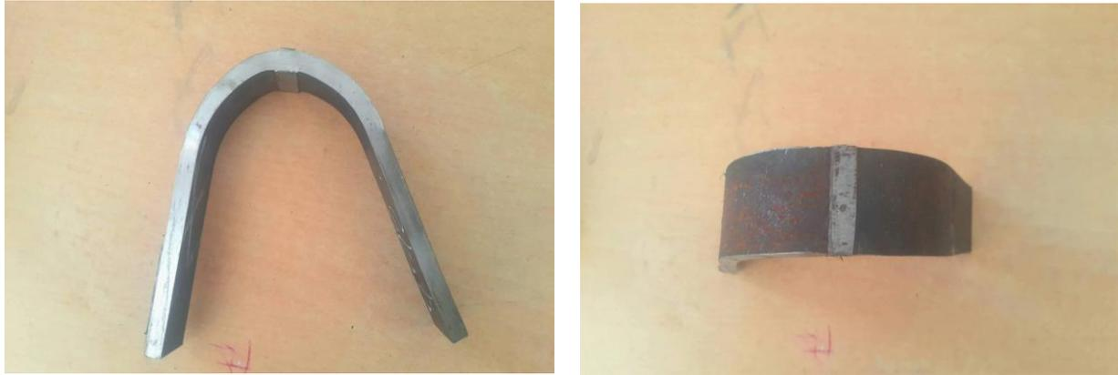
*Figure 5. 15 : Les éprouvettes après l'essai de pliage*
