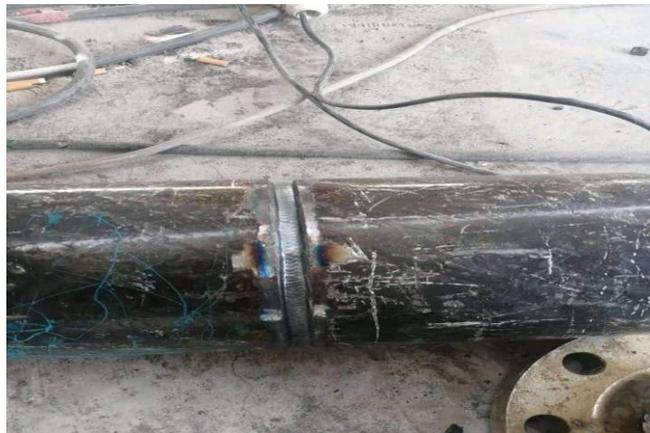
*Figure 5. 5 : le soudage TIG après l'opération de soudage*
