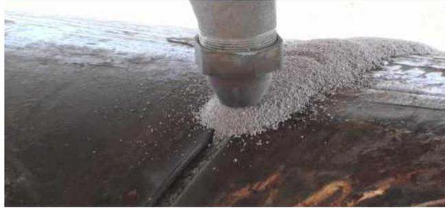
Figure 2. 6: photos montrant le principe de soudage SAW
