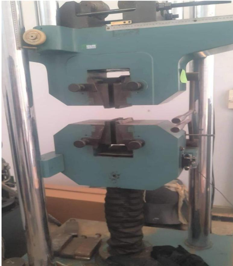
*Figure 5. 9 : Machine de traction utilisée.*
