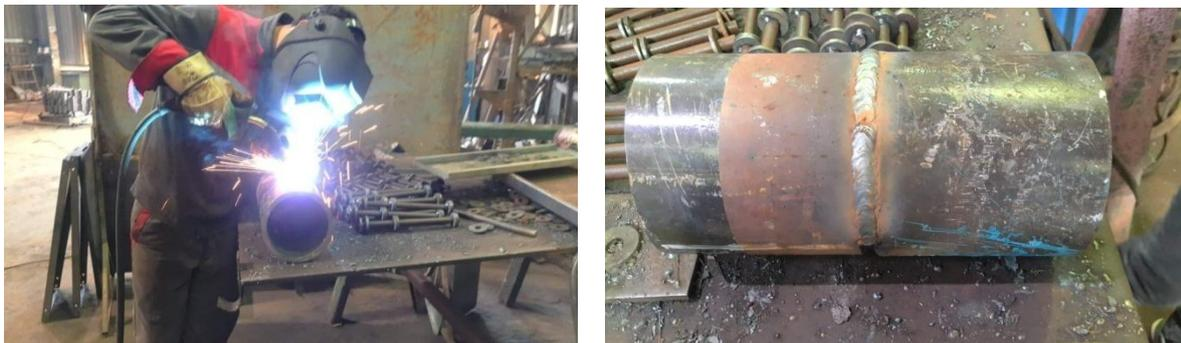
*Figure 5. 7 : le soudage GMAW pendant et après l'opération de soudage*
