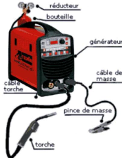
*Figure 2. 5: les compositions de poste de soudage MIG-MAG*
