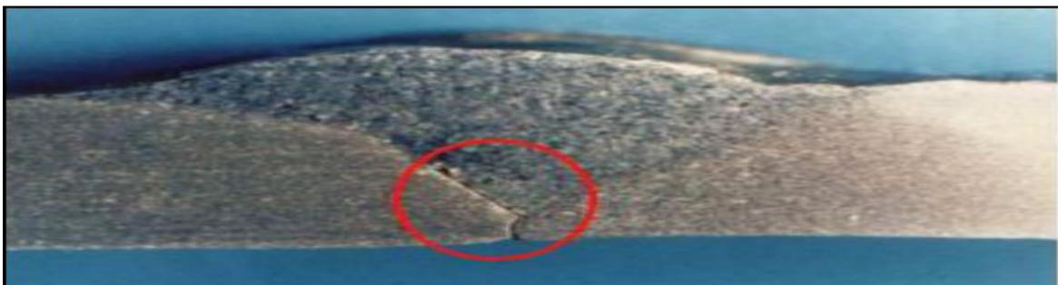
Figure 4.15 : Manque de pénétration et collage en bord de chanfrein; [30].
